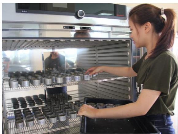
ภาพที่ 27 การติดตามความชื้นในดินและความหนาแน่นรวมของดิน(ก่อนและหลัง) บริเวณจัดทำธนาคารน้ำใต้ดินแบบปิด
