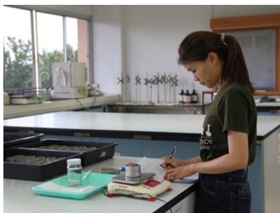
ภาพที่ 27 การติดตามความชื้นในดินและความหนาแน่นรวมของดิน(ก่อนและหลัง) บริเวณจัดทำธนาคารน้ำใต้ดินแบบปิด
